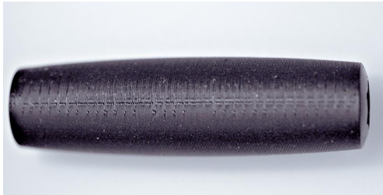
Obrázok 0-7 – Spojovacia linka pre proces extrúzie. (Zdroj: CP-GmbH/FH-Aachen)
