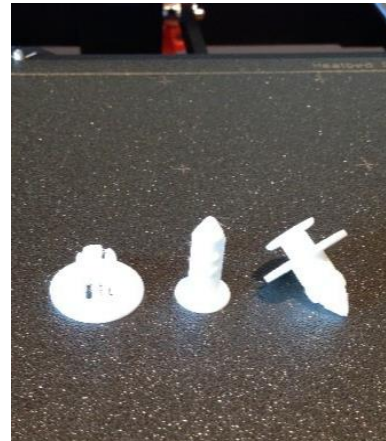
Obrázok 7-2 – CAD model a tlač so sponou (vpravo) model a tlač typu Push Rivet (vľavo)
