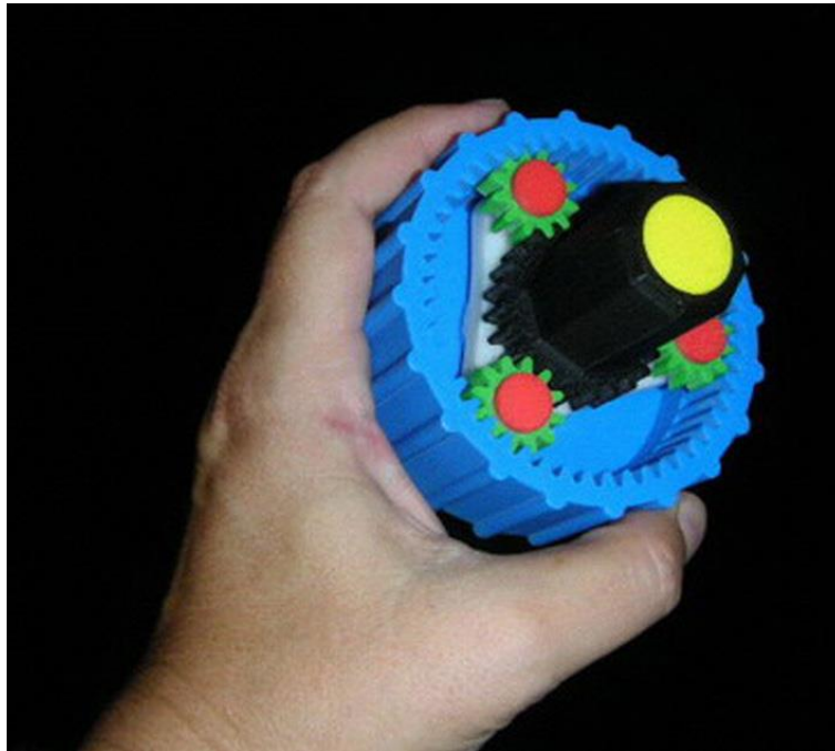
Obrázok 0-11 - Model taveného ukladania , farebný funkčný model ABS (Zdroj: Stratasys)
