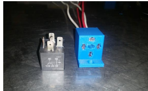
Obrázok 7-6 – Držiak relé CAD modely and výtlačky
