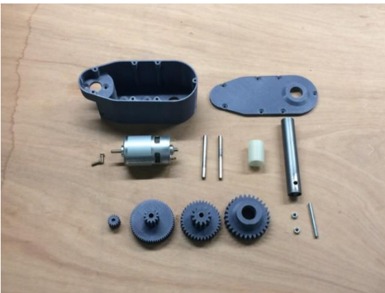
Obrázok 7-9 – Prevodovka CAD modely a výtlačky
