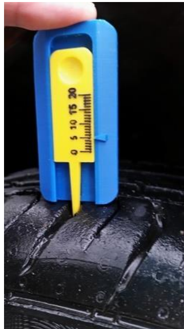
Obrázok 7-5 – Meranie drážok pneumatiky CAD modely a tlač
