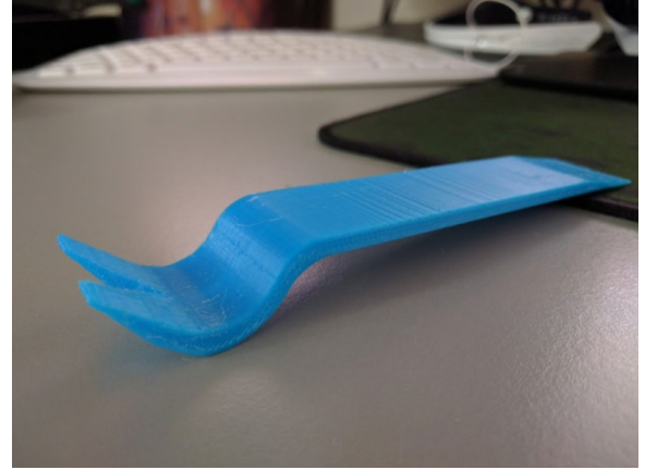
Şekil 7-7 – Kırpma kaldırma aracı CAD modeli ve baskısı
