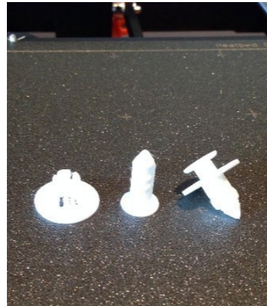
Şekil 7-2 – İtmeli Pim klipi CAD modeli ve baskısı (sağda) ve Kenet Mili CAD modeli ve baskısı (sol)
