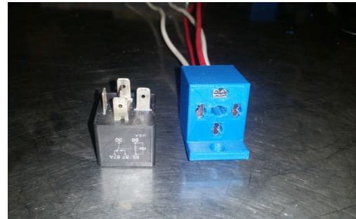
Şekil 7-6 – Rôle tutucu CAD modeli ve baskıları
