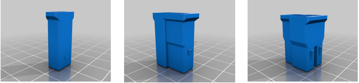
Şekil 7-3 – Elektrik Bağlantı Noktaları CAD modelleri
