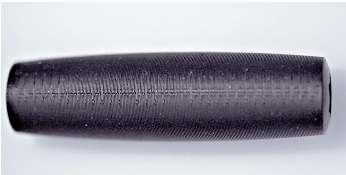
Figure 5-8 – Linha conjunta no processo de extrusão. (Source: CP-GmbH/FH-Aachen)
