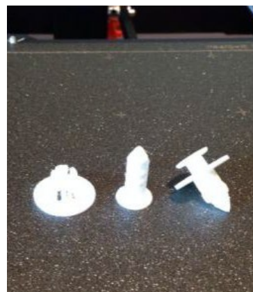
Figura 7-2 - Clip Push Pin modello CAD e stampa (destra) e Push Rivet modello CAD e stampa (sinistra)
