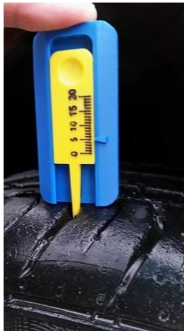
Abbildung 7-5 - Messen der Reifenrillen CAD-Modelle und Druck
