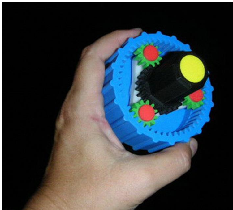
Abbildung 5-12 - Fused Deposition Modeling, farbiges ABS-Funktionsmodell (Quelle: Stratasys)
