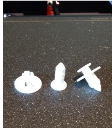
Abbildung 7-2 - Push Pin Clip CAD-Modell und Druck (rechts) und Push Rivet CAD-Modell und Druck (links)
