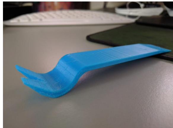
Abbildung 7-7 - Entgratungswerkzeug CAD-Modell und Druck
