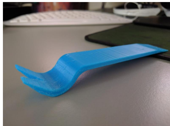
Εικόνα 7-7 – Εργαλείο επιδιόρθωσης και αφαίρεσης CAD μοντέλο και εκτύπωσης
