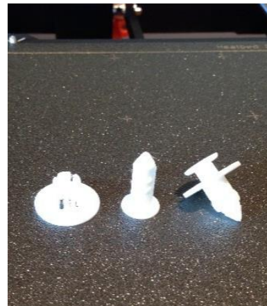
Εικόνα 7-2 – Push Pin clip CAD μοντέλο και εκτύπωση (δεξιά) και Push Rivet CAD μοντέλο και εκτύπωση (αριστερά)
