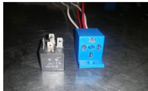
Εικόνα 7-6 – Υποδοχέας ρελέ CAD μοντέλου και εκτύπωσης
