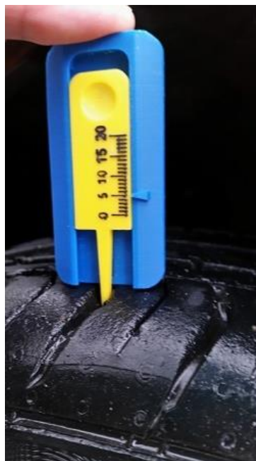
Εικόνα 7-5 – Μετρητής βάθους αύλακα ελαστικού CAD μοντέλου και εκτύπωσης
