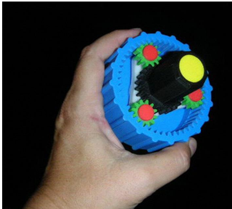
Εικόνα 5 12- Μοντελοποίηση με τήξη εναπόθεσης, έγχρωμο λειτουργικό μοντέλο ABS
