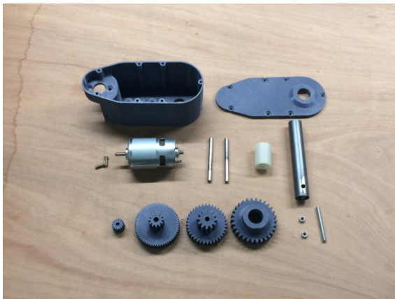
Εικόνα 7-9 – Κιβώτιο ταχυτήτων CAD μοντέλα και εκτυπώσεις
